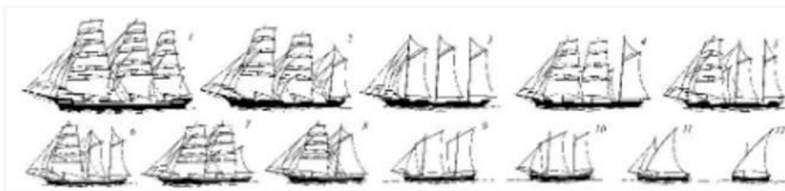
JEDRENJAK, 1. križnjak, 2. bark, 3. goleta, 4. bark-škuna, 5. barkantina, 6. škuna-bark, 7. brik, 8. škuna, 9. trabakul, 10. pelig, 11. bracara, 12. leut
