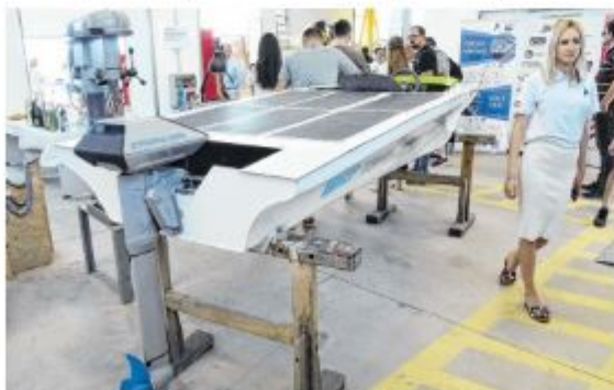
Oba broda imaju električnu propulziju i sustav nadopunjavanja baterija fotonaponskim ćelijama
